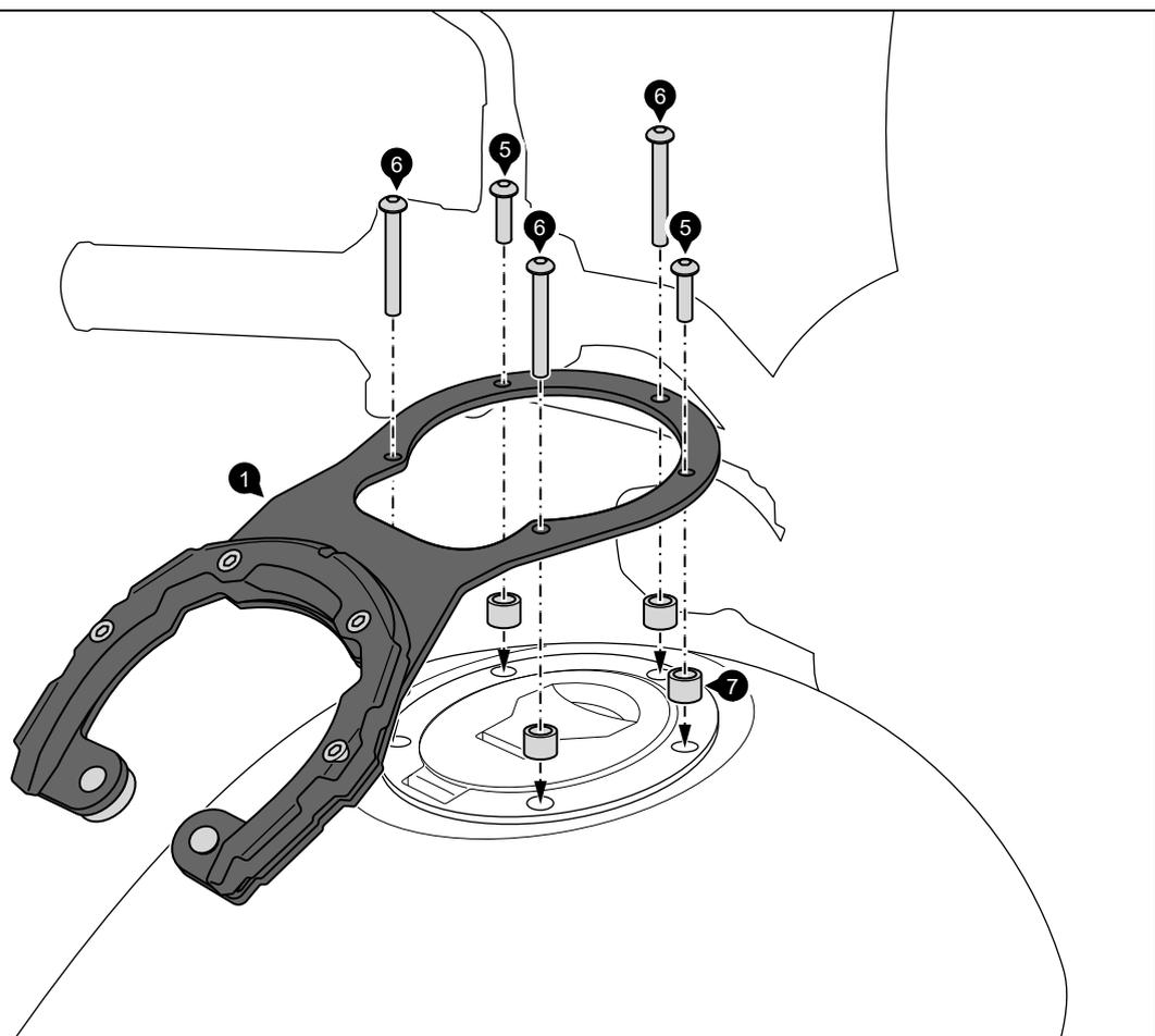
Retirez les vis d'origine des points de fixation indiqués.
