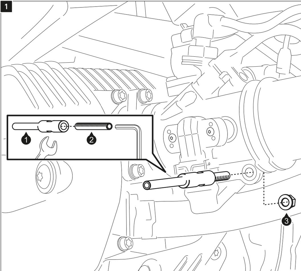
Verschrauben Sie die Distanzbuchse (1) mit dem Gewindestift (2), wie in der Detailzeichnung gezeigt. Entfernen Sie die originale Schraube vom gezeigten Anbaupunkt und verschrauben Sie an deren Stelle die Distanzbuchse (1) mit der Mutter (3).
