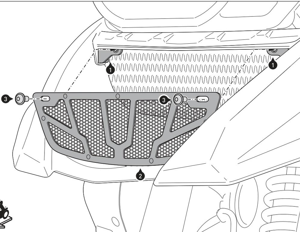
Verschrauben Sie den Öl-Kühler-schutz (2) **beidseitig** an den Anbauwinkeln (1).
