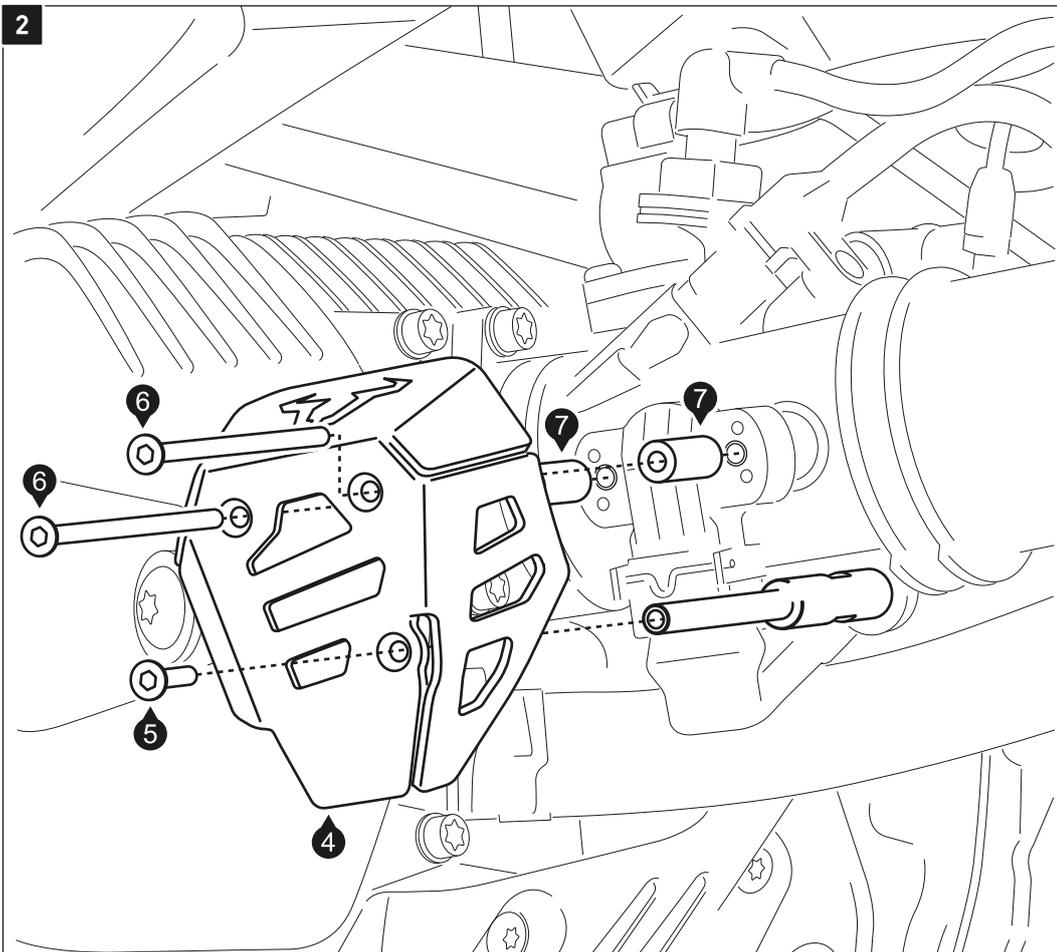
Entfernen Sie die originalen Schrauben von den oberen beiden Anbaupunkten. Verschrauben Sie anschließend das Schutzblech (4) am Fahrzeug, wie in der Zeichnung gezeigt.
