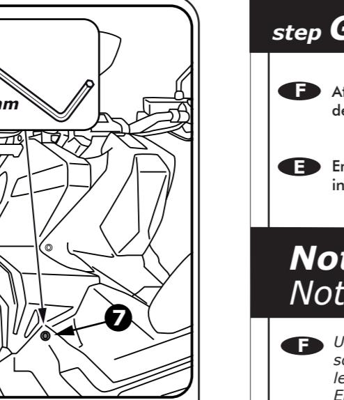
**E** Fije el cubrepiernas de los dos lados, utilizando los tornillos del scooter, pasándolos a través de los agujeros en el punto 7.
