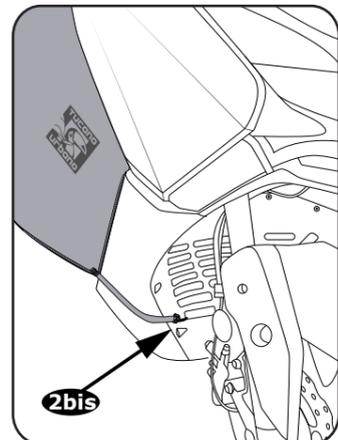
**I** Attaccare i ganci dei nastri 2bis al bordo della carrozzeria all'interno del vano ruota.
