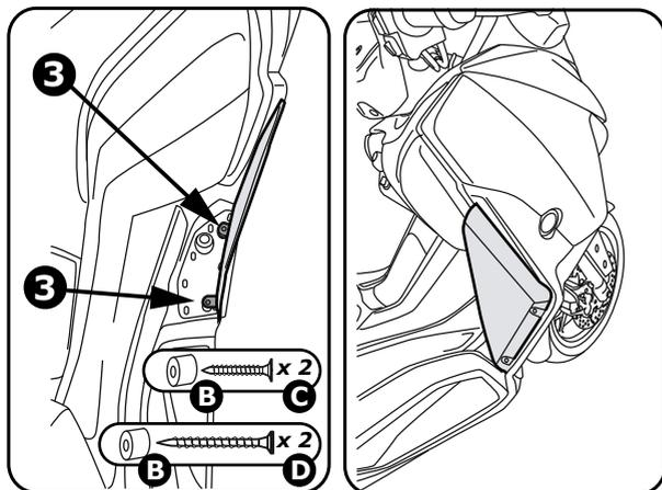
**F** Enlever la vis du point 3. Monter le profil rigide sur ce trou en utilisant la vis (C et D) dans les bagues-en-tretoise (B) en dotation.
