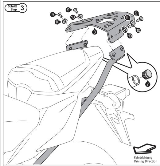
Verschrauben Sie das ALU-RACK (8) wie gezeigt. Benutzen Sie flüssige Schraubensicherung. Ziehen Sie anschließend alle Schrauben an.
