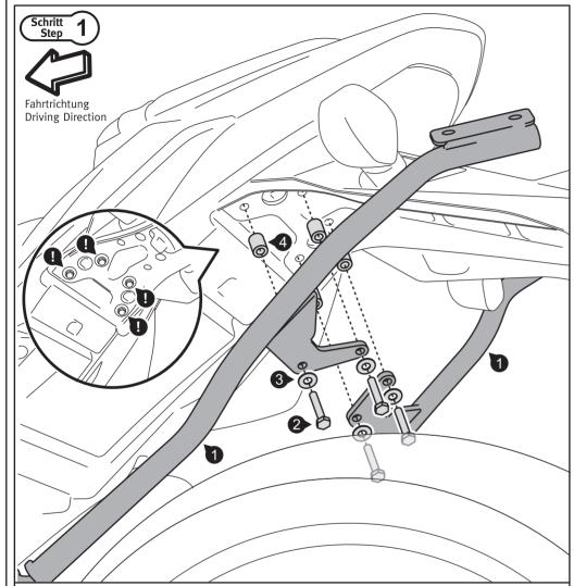
Entfernen Sie beidseitig die Soziusfußrasten vom Fahrzeug. Lösen Sie anschließend die im Detailbild markierten originalen Schrauben. Verschrauben Sie nun die beiden Unterbau-Elemente (1) wie gezeigt. Benutzen Sie flüssige Schraubensicherung. Ziehen Sie die Schrauben noch nicht an.
