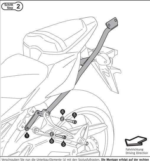
Fahrzeugseite analog zur linken Fahrzeugseite. Benutzen Sie flüssige Schraubensicherung. Ziehen Sie die Schrauben noch nicht an.
