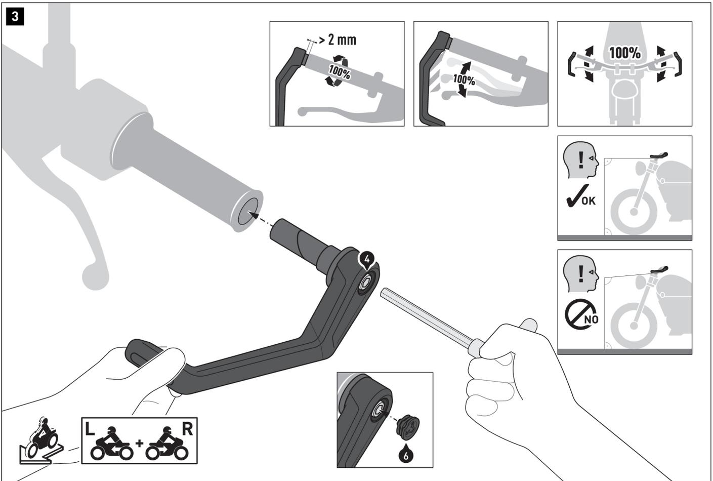
Insérez les douilles de serrage des protège-leviers dans les extrémités ouvertes du guidon des deux côtés jusqu'au collet.
