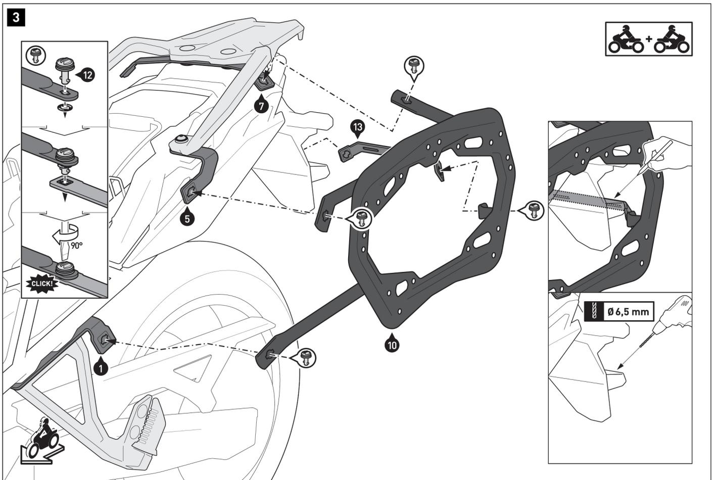
Reliez les supports latéraux [10] et [11] aux pattes de fixation [1], [2], [5] et [6] et aux barres de jonction [7] et [13] à l'aide des verrouillages rapides [12]. Fixez les verrouillages rapides avec les rondelles de sécurité. À l'aide d'un objet pointu par exemple un tournevis, marquez les points de perçage sur la face extérieure du support de plaque d'immatriculation. Démontez les supports latéraux [10] et [11] avec la barre de jonction [13].
