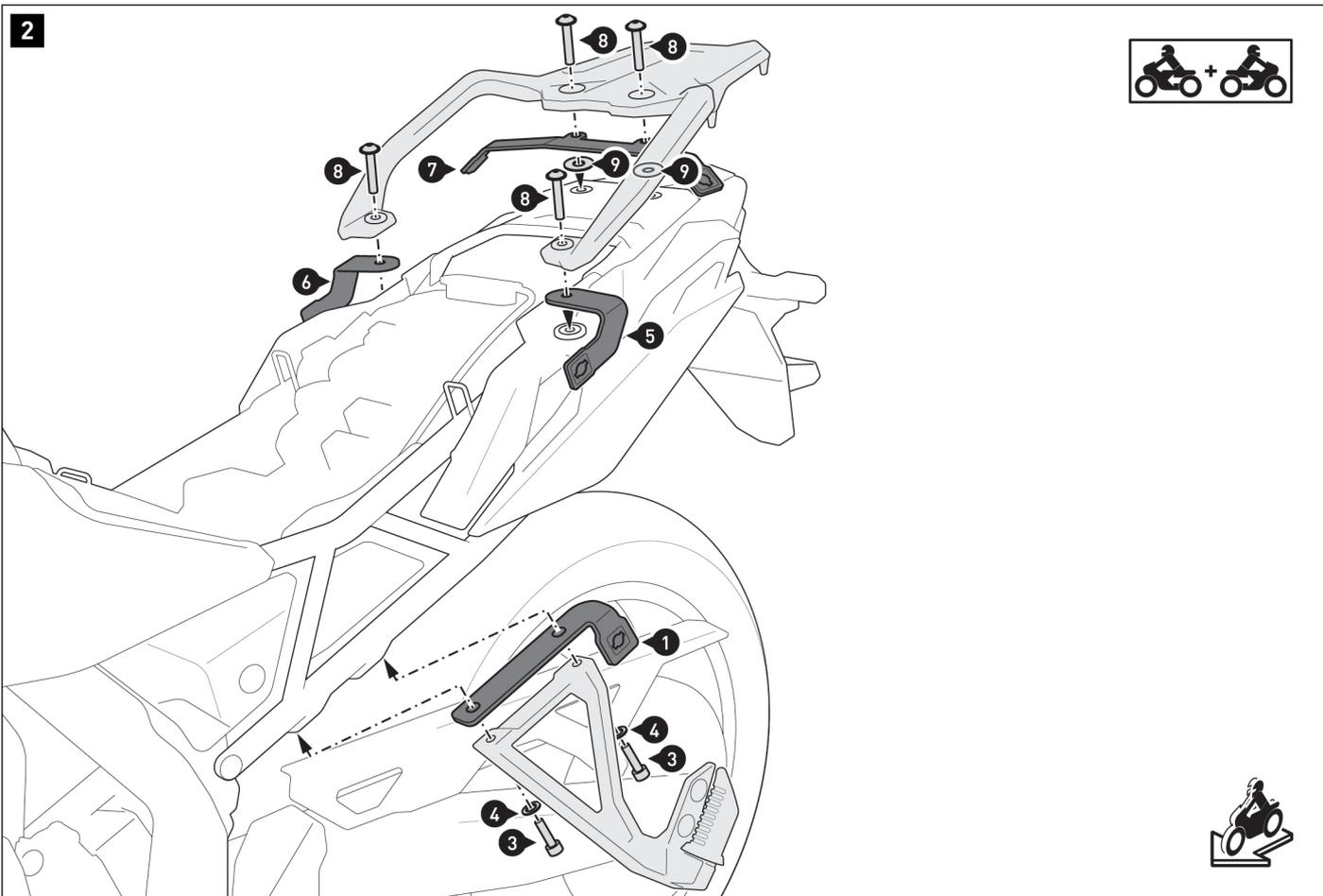
Vissez les pattes de fixation (1), (2), (5) et (6), ainsi que la barre de jonction (7) des deux côtés du véhicule.
